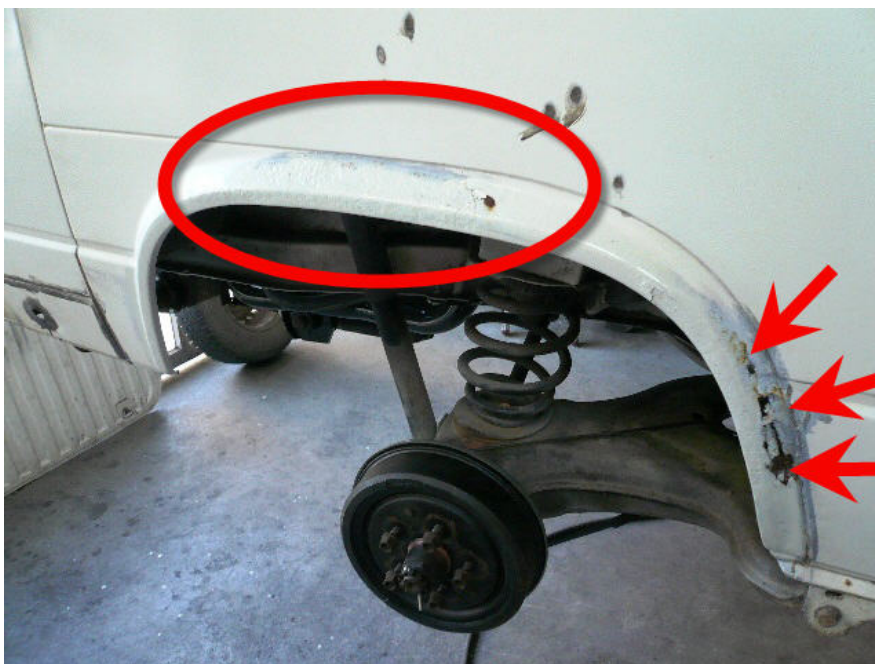
Wie zu sehen ist weist der Radlauf erhebliche An- und Durchrostungen auf.
