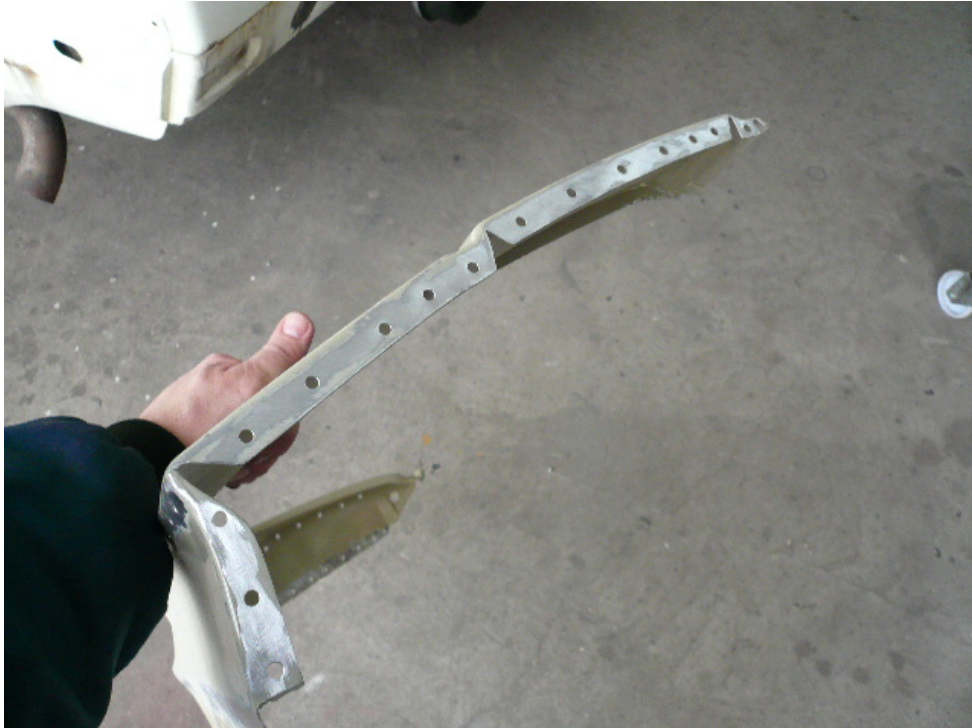
Hier die hintere Anlagefläche des Radlaufs, ebenfalls bereits gelocht
