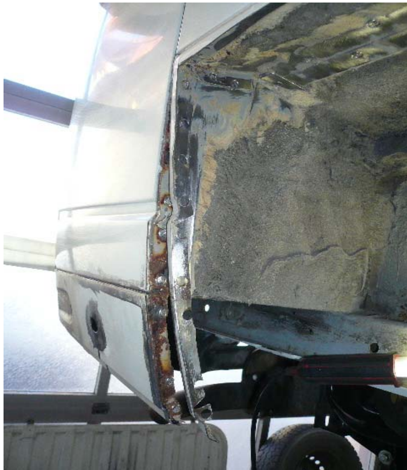
Nun werden die Schweißpunkte mit dem Schweißpunktfräser aufgebohrt. Achtung: nicht zu tief bohren sonst ist man schnell „durch“. Ggf. lieber noch mal nachbohren. Auf diesem Bild kann man auch sehen daß die Blechfalze angerostet sein können, selbst wenn von außen noch nichts zu sehen ist.
