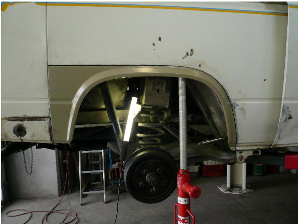
Hier die hintere Anlagefläche des Radlaufs, ebenfalls bereits gelocht
