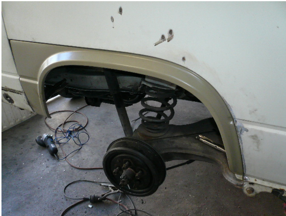
Das Neuteil wird zunächst mal auf Paßgenauigkeit geprüft. Gut geeignet zum fixieren sind hier Gripzangen, zwei bis drei Stück sollten reichen. Falls es nötig sein sollte den Radlauf zu korrigieren, dann muß das jetzt geschehen, daher lieber einmal zuviel als einmal zu wenig kontrollieren.
