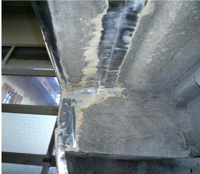
Die selbe Stelle hinten im Radkasten. Auch hier sind die Schweißpunkten nun zugänglich.
